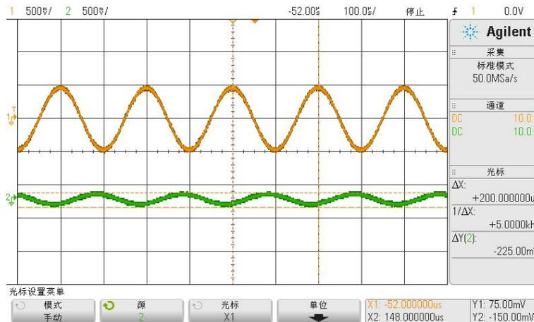
图 2.10.16 5KHz 的正弦波信号及响应信号波形图
