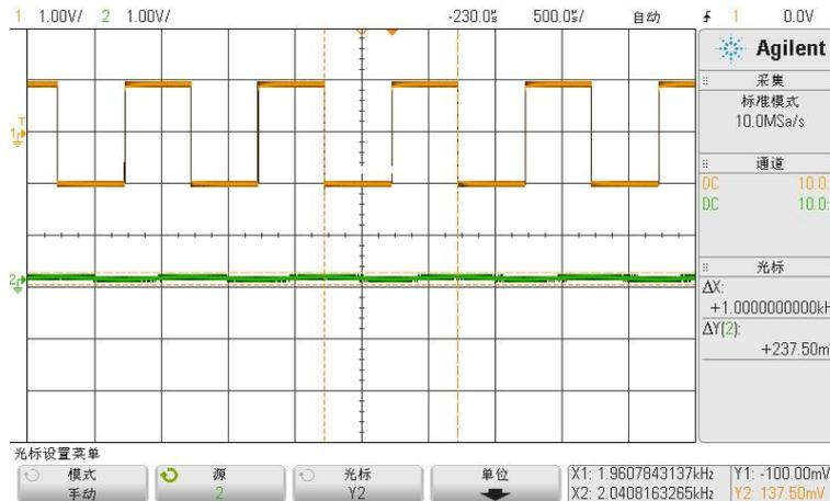
图 2.6.13  $R = 10K\Omega$ ,  $C = 1\mu F$ 时的积分效果
