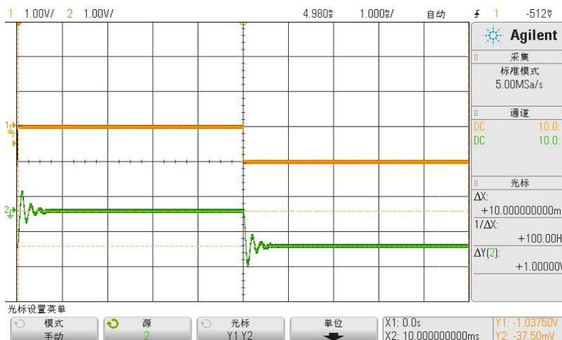
图 2.11.6 电路过阻尼时响应波形
