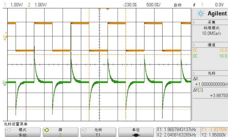
图 2.6.18  $R = 510\Omega$ ,  $C = 0.1\mu F$ 时的微分效果
