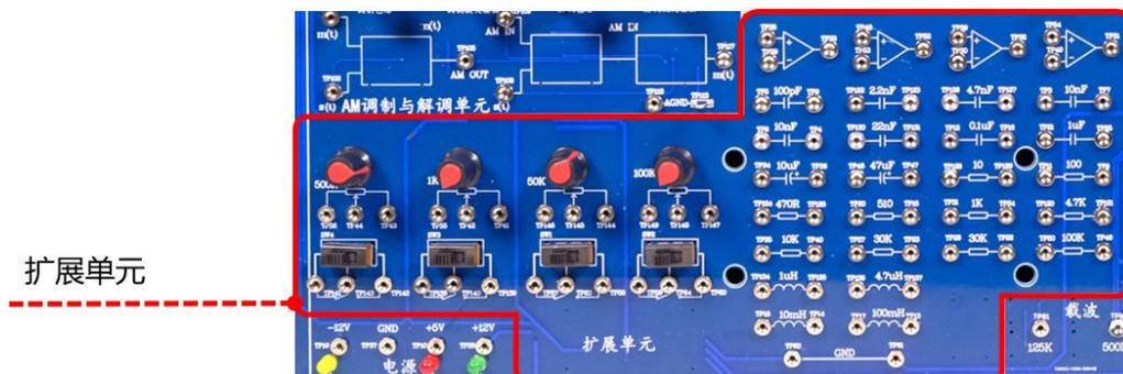
图 2.6.5 一阶电路时域分析实验操作区
