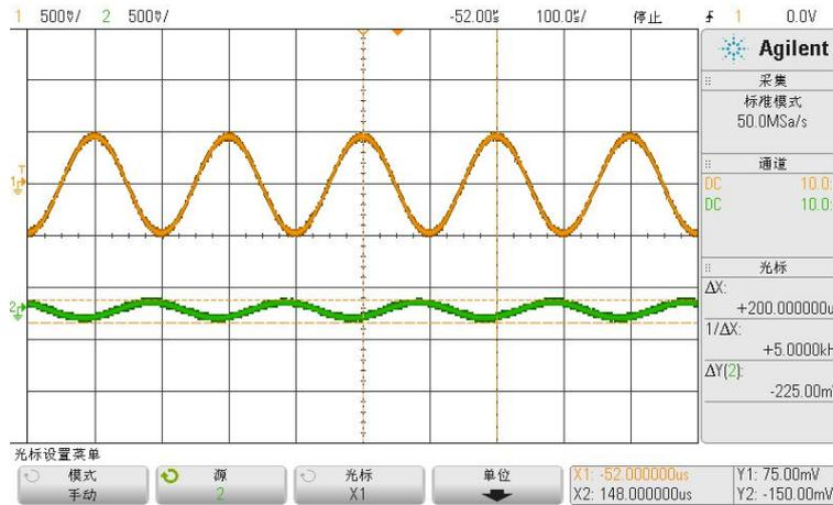
图 1.10.22 5KHz 的正弦波信号及响应信号波形图
