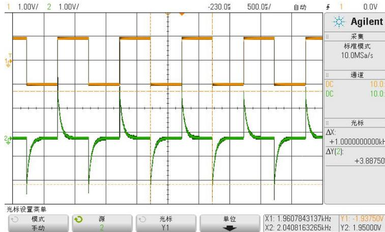
图 1.6.27  $R = 510\Omega$ ,  $C = 0.1\mu F$ 时的微分效果
