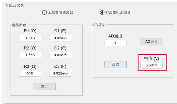
图 1.4.66 滤波后信号的最大值
