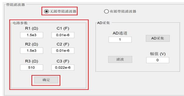
图 1.5.21 无源带阻滤波器电路参数配置
