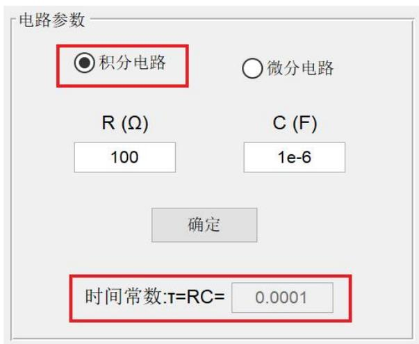
图 1.6.14 设置积分电路参数
