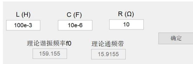
图 1.13.24 MATLAB 计算 RLC 串联电路的谐振频率及通频带
