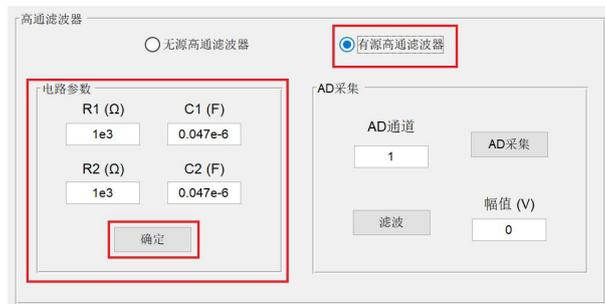
图 1.4.29 有源高通滤波器电路参数配置
