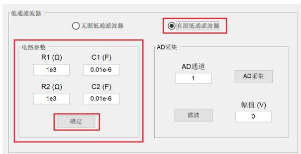
图 1.4.26 有源低通滤波器电路参数配置
