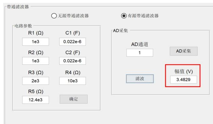
图 1.4.58 滤波后信号的最大值
