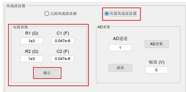
图 1.5.16 有源高通滤波器电路参数配置
