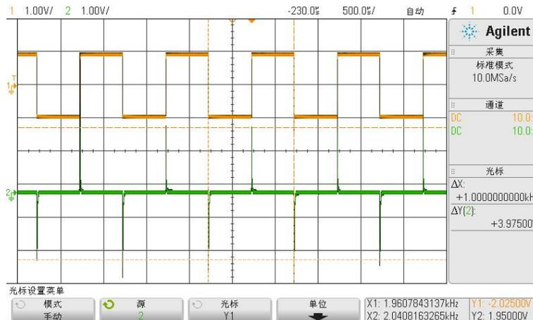
图 1.6.24  $R = 510\Omega$ ,  $C = 0.01\mu F$  时的微分效果
