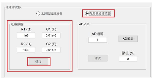
图 1.5.13 有源低通滤波器电路参数配置
