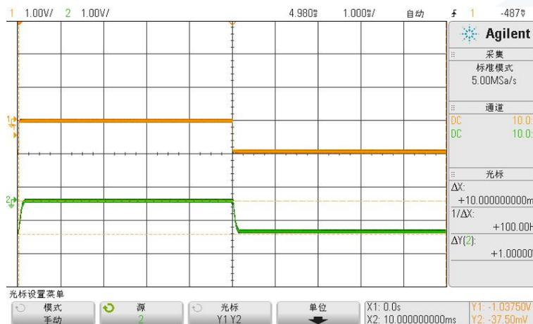
图 1.11.15 电路临界阻尼时响应波形
