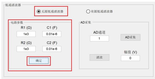
图 1.4.24 无源低通滤波器电路参数配置
