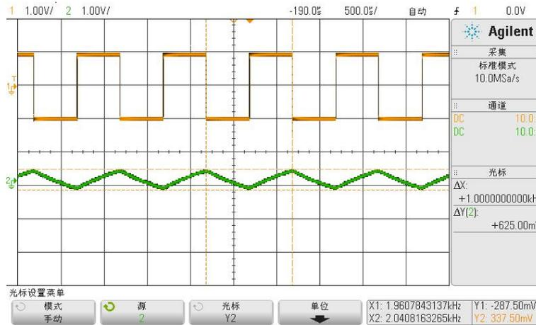
图 1.6.19  $R = 10K\Omega$ ,  $C = 0.1\mu F$ 时的积分效果
