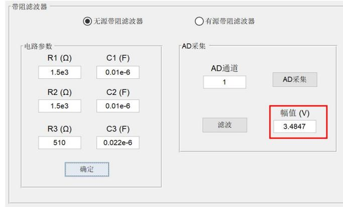
图 1.4.62 滤波后信号的最大值
