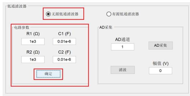
图 1.5.11 无源低通滤波器电路参数配置
