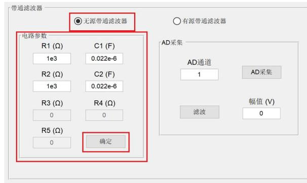
图 1.4.31 无源带通滤波器电路参数配置
