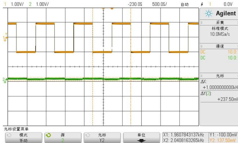
图 1.6.22  $R = 10K\Omega$ ,  $C = 1\mu F$ 时的积分效果
