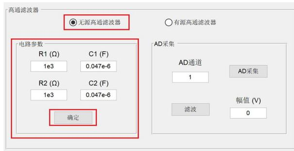
图 1.4.28 无源高通滤波器电路参数配置
