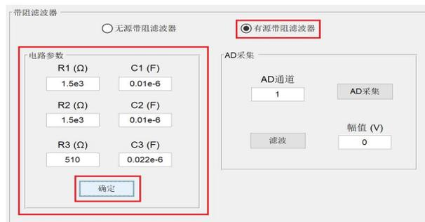
图 1.4.35 有源带阻滤波器电路参数配置
