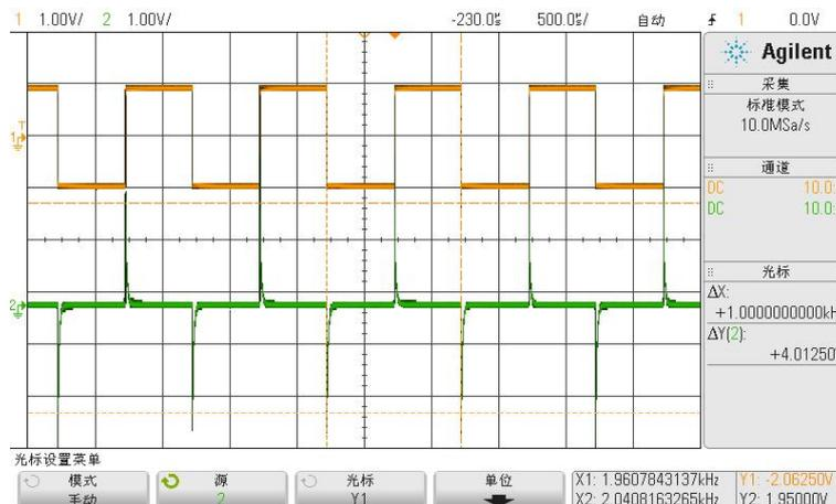
图 1.6.25  $R = 1K\Omega$ ,  $C = 0.01\mu F$  时的微分效果
