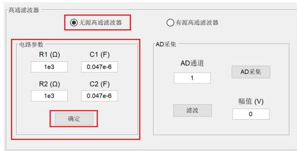
图 1.5.15 无源高通滤波器电路参数配置
