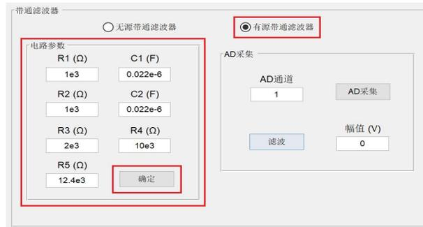
图 1.5.19 有源带通滤波器电路参数配置
