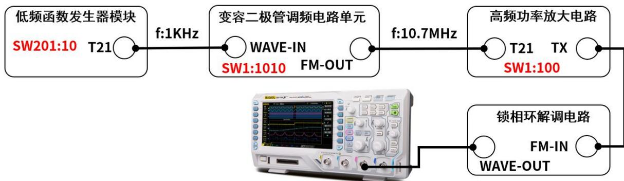
图 2.17.6 锁相环解调实验接线
