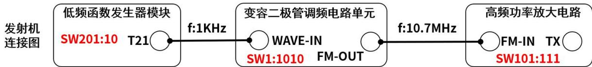
图 2.20.2 调频接收机电路实验-发射机接线
