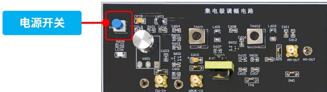
图 1.3.2 功能电路独立电源开关
