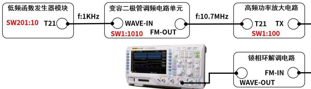
图 2.15.6 锁相解调实验接线
